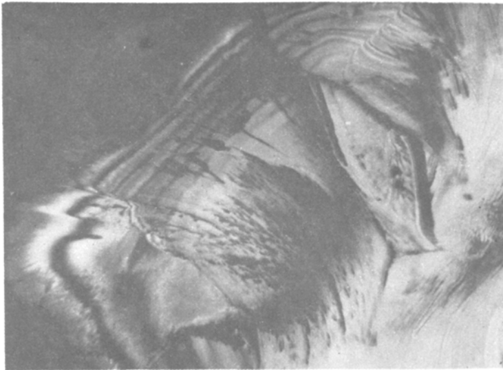
Abb. 8 Zintronensäuremonohydrat 20 °C. Vergrößerung ca. 40 ×, + Polarisatoren, Gipskompensator
